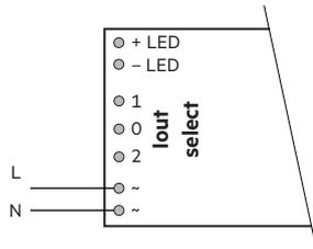
**800 mA:** Klemmen 0 und 1 verbunden mit 0 Ω Draht (max. 6 cm Länge) oder Widerstand ADV Plug Type A BR (Artikelnummer: 28001771)
