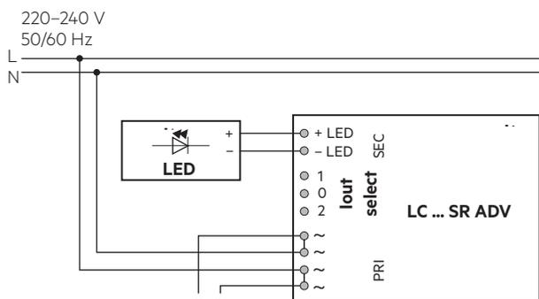
Gerät mit Durchgangsverdrahtungsfunktion.
